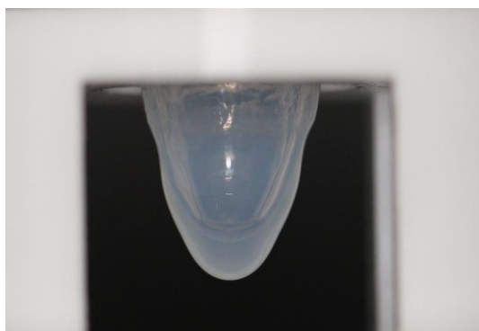
Ein künstlich generierter Ventrikel auf Hydrogelbasis
